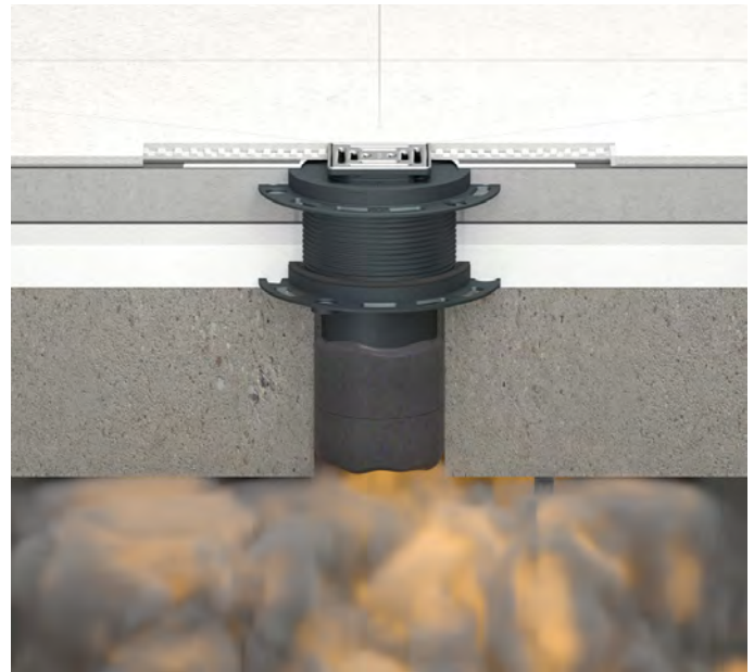
2. Deckendurchführung wird verschlossen
